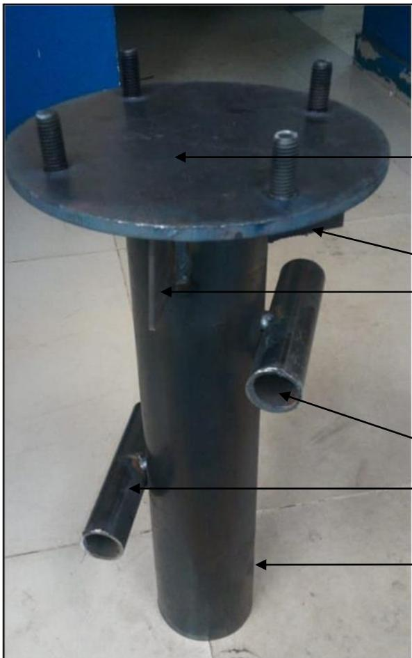
Brida Inferior Lam A36 3/8" de 22 cms 4 tornillos acero 1045 tuerca de seguridad,
