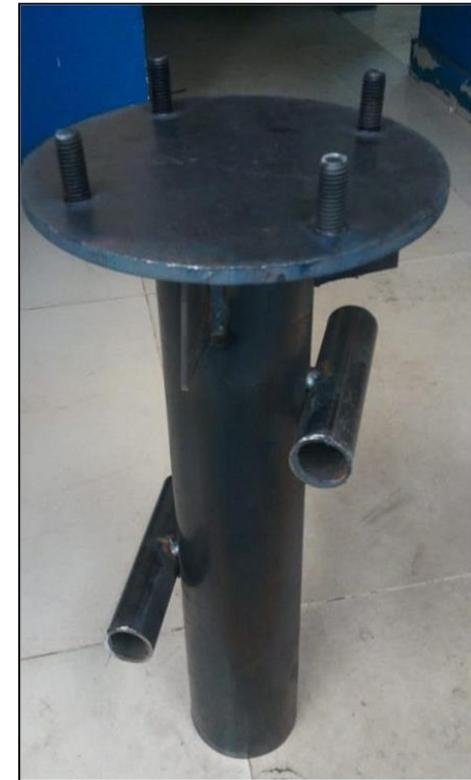
**En todos los tipos de instalación se requiere el dado de concreto de 3000 psi y el anclaje**
